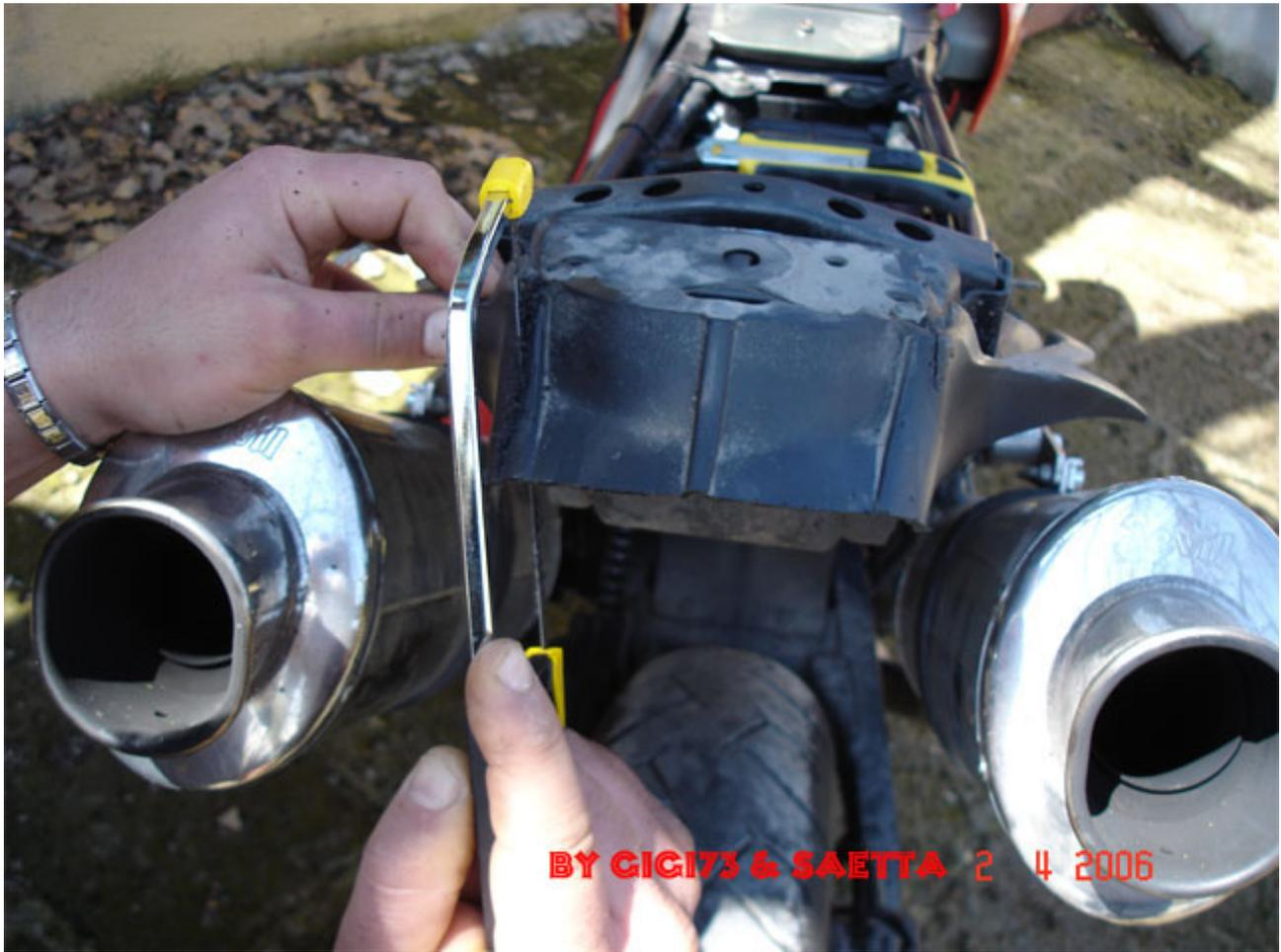
E' importante portare come esempio il faretto poggiandolo sulla sede dove lo si vuole montare. Una volta tagliate le due estremità tagliare anche al centro in modo da facilitare i tagli successivi per eliminare la plastica in eccesso e per poter limare e rifinire piano piano riportando il faretto sopra per eventuali modifiche.
